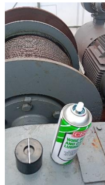
รูปที่ 77 สเปรย์หล่อลื่นลวดสลิง เพื่อลดการเสียดสี
